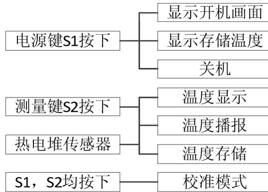
图 1 BM 耳温枪应用方案功能框图
