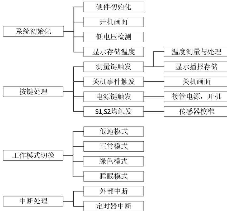
图 18 耳温枪软件组成框图
